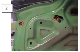
Remove the (4) 10mm buts securing the factory spoiler.
